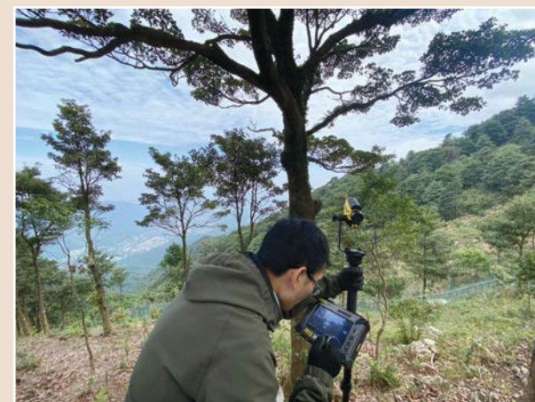
卓孟龍使用鐳射測距儀精確地繪製實驗樣地內樹木和其他特徵的位置圖
